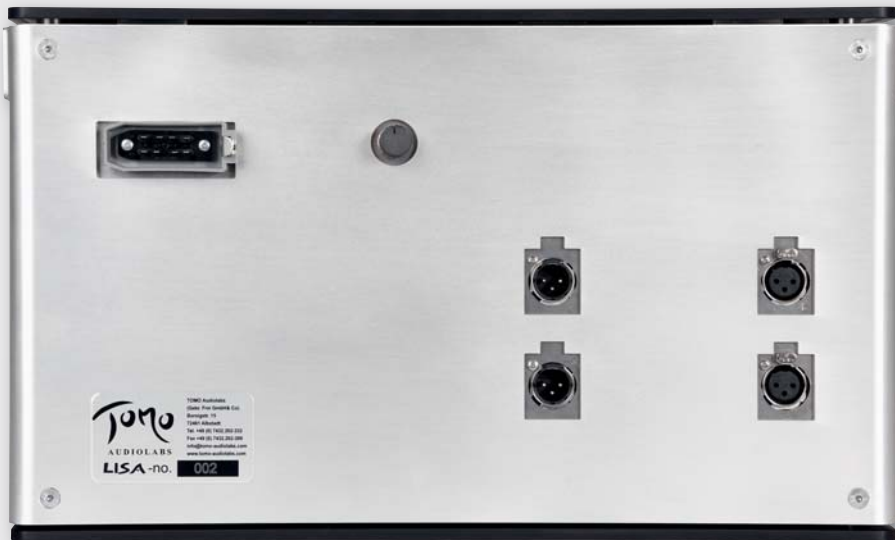
Die Rückseite des sechs Höhereinheiten messenden Equalizers gibt sich spartanisch. Sie enthält XLR-Anschlüsse für die Ein- und Ausgänge sowie eine Buchse für das externe Netzgerät. Besonderheit: Über das Poti lässt sich die Helligkeit der hinterleuchteten Taster sowie des rot beleuchteten Schlitzes in der Mitte regulieren.
