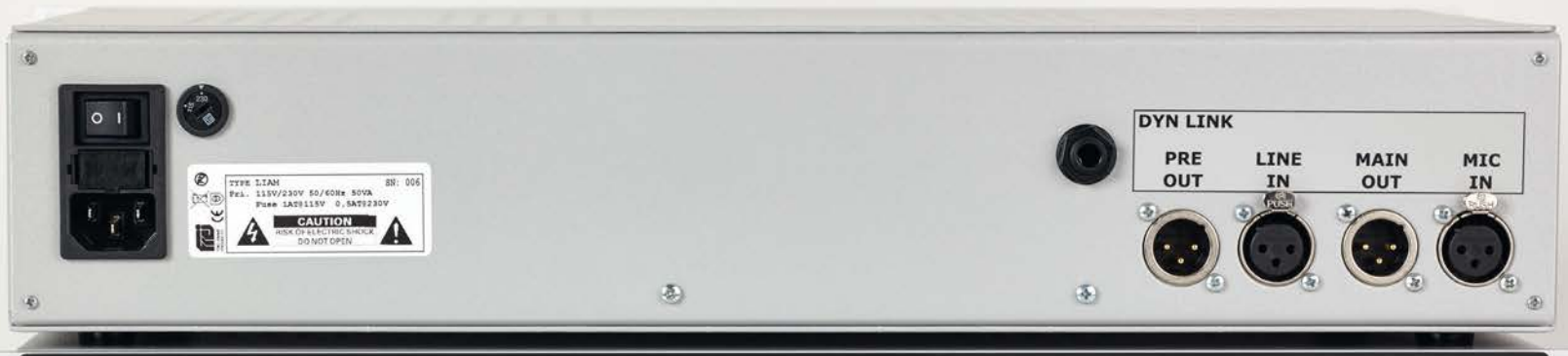
Vier XLR-Anschlüsse und eine Klinken-Buchse zieren die Rückseite von LIAM. Letztgenannte synchronisiert im Stereo-Betrieb mit einem zweiten LIAM die Dynamik-Sektion beider Geräte. Außer dem Mikrophon-Eingang und einem Summen-Ausgang, lässt sich auch das reine Vorverstärker-Signal herausführen. Der Line-Eingang dient zum Einspeisen externer Signale in den EQ.
